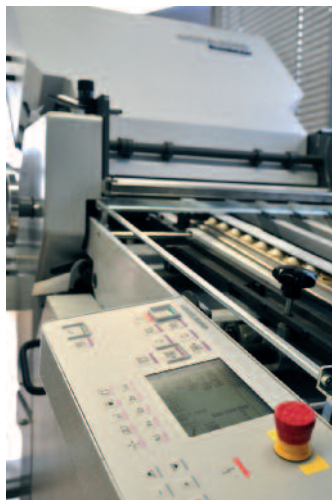
Durch die neue Maschinensteuerung CCT werden die Stahlfolder Ti 52 und Ti 36 über ein leicht zugängliches Pult am Anleger bedient.
